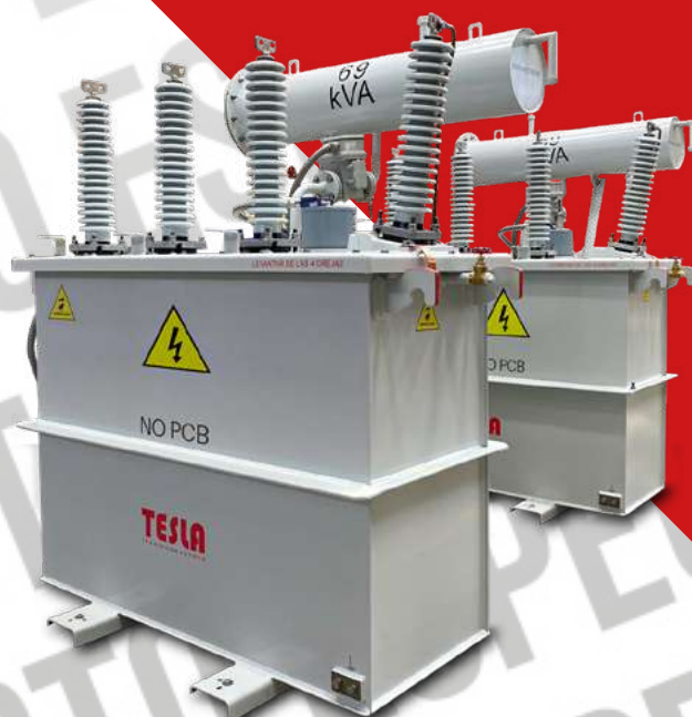
TRANSFORMADOR ACEITE ESPECIAL TIPO ZIG ZAG POTENCIA CONTINUA: 69 kVA POTENCIA DE FALLA: 2300 kVA CORRIENTE DE FALLA: 200 A TIEMPO DE FALLA: 10 seg. BIL: 200 kV
